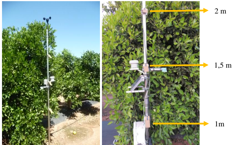
Figura 5.2: Posición de los sensores de humectación foliar Spectrum y Hobo, sensores de temperatura y HR y el anemómetro a 3 m de altura en los lados este y oeste en la copa de un árbol de cítrico.
