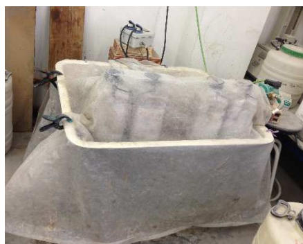
Figura V.7.1 - Activador alcalino en baño térmico a 65°C
