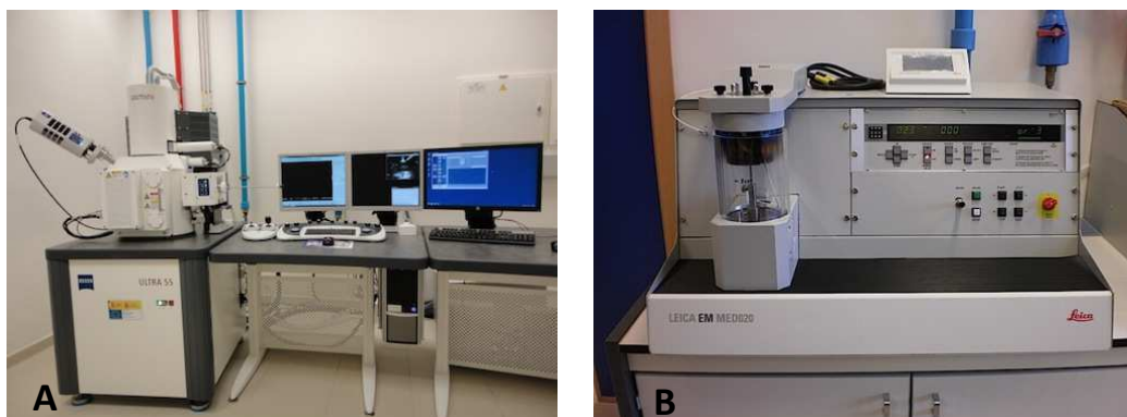
Figura IV.2.11 – A) Microscopio electrónico de barrido de emisión de campo (FESEM). B) Recubridor de alto vacío.
