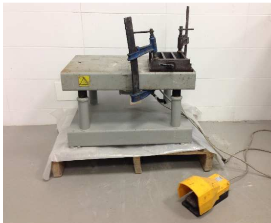
Figura IV.2.19 – Molde sujeto a la mesa vibratoria utilizada
