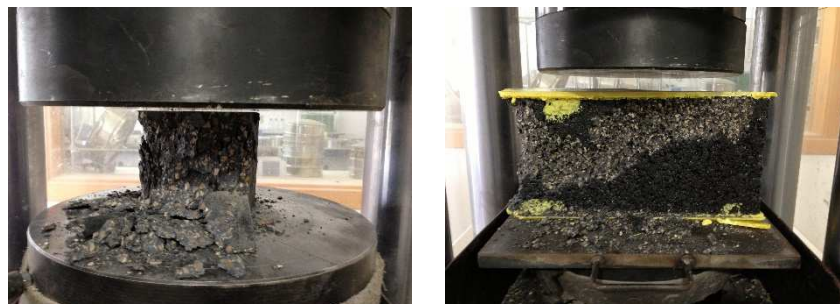
Figura IV.2.36 – Probeta cúbica y bloque después de su rotura
