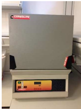
Figura IV.2.1 – Mufla utilizada para el ensayo de pérdida al fuego
