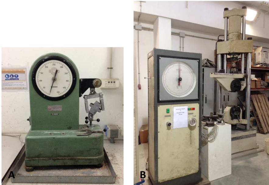
Figura IV.2.32 – Prensas utilizadas para ensayos de flexión (A) y compresión (B) de morteros
