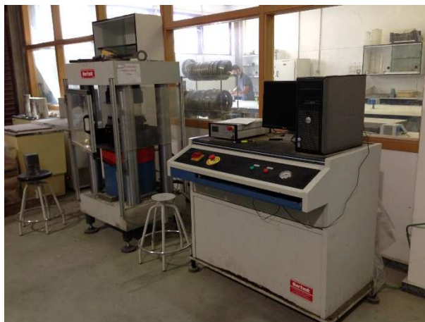
Figura IV.2.33 – Prensa Ibertest para la rotura de hormigón geopolimérico
