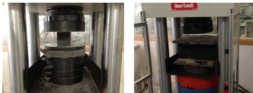
Figura IV.2.34 – Colocación de las piezas en la prensa
