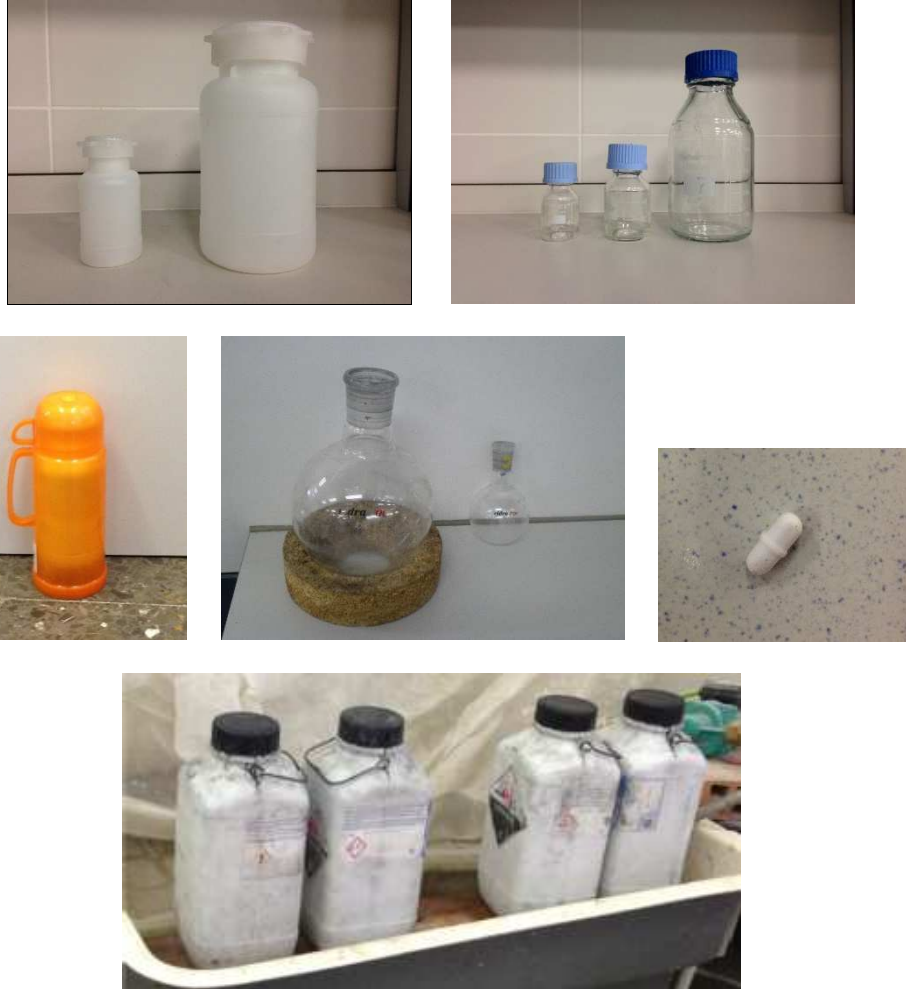
Figura IV.2.17 – Útiles necesarios para la elaboración del activador alcalino
