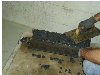
Figura IV.2.28 – Proceso de enrase de los cubos
