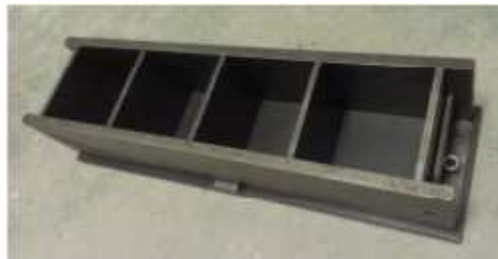
Figura IV.2.20 – Moldes utilizados para la fabricación de hormigón geopolimérico
