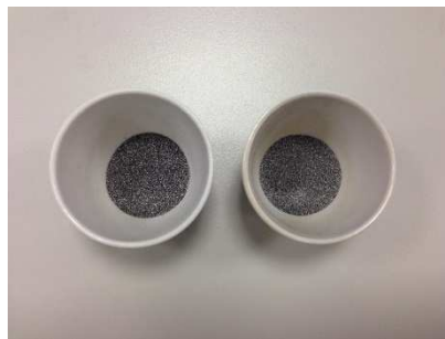
Figura IV.2.2 – CCAO después del ensayo de pérdida al fuego
