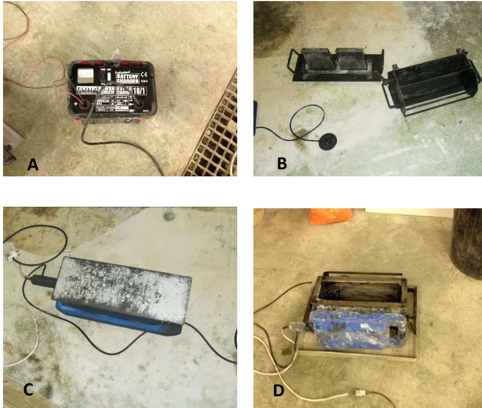
Figura IV.2.21 – Bloquera autónoma: A) Batería. B) Molde interior y exterior. C) Máquina vibratoria. D) Conjunto montado
