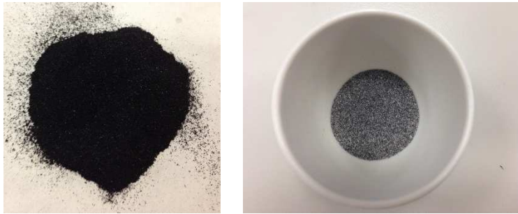
Figura V.1.1 – A) Ceniza de cáscara de arroz original. B) Ceniza de cáscara de arroz calcinada
