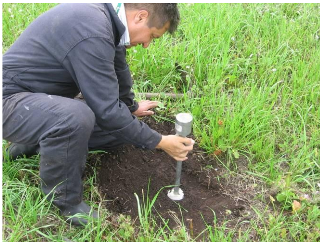
Figura 3.9 Toma de muestras inalteradas para los análisis de física de suelos.
