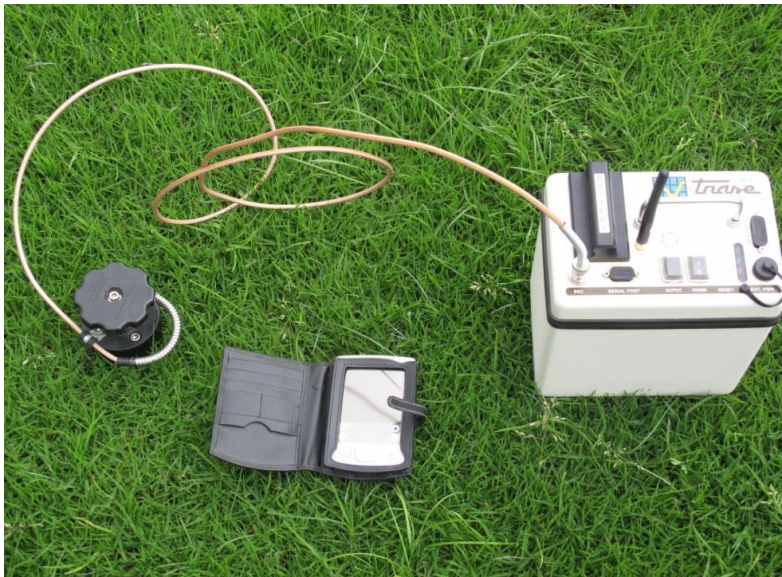
Figura 3.10 Control de humedad del suelo empleando el TDR.
