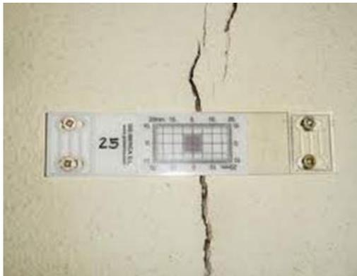
*Ilustración 57 Fisurómetro, Fuente Wikipedia.*
