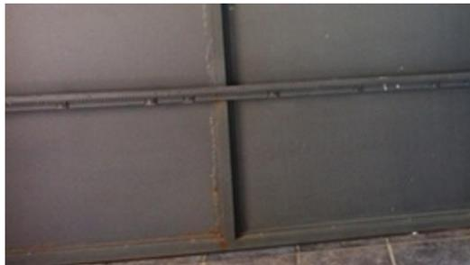
*Ilustración 67 Corrosión por aireación diferencial. Fuente: Internet (Google: corrosión por aireación diferencial)-22/06/2015 19:33*
