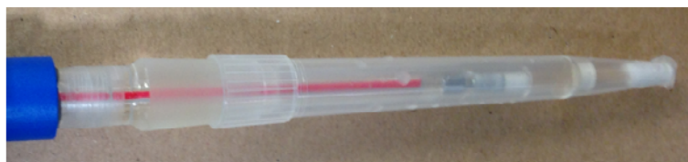
Figura 3.5. Soporte plástico, con punta de algodón, que evita la contaminación del electrodo de referencia.
