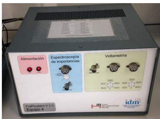
Figura 3.2. Aspecto exterior del equipo electrónico de medida de la señal voltamétrica .
