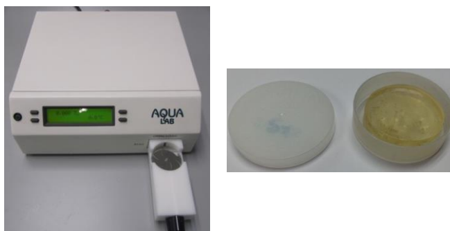
Figura 3.4. La figura de la izquierda muestra el equipo utilizado para la medición de la a_w . A la derecha se observa uno de los geles utilizados para la realización de las medidas.
