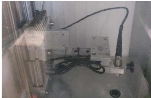
**Figura 3.4. Equipo de medición de espesor y presión. Se observa el carro deslizante, la célula de carga y la colocación de los transductores.**
