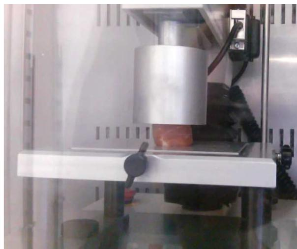
**Figura 3.10. Ensayo de compresión/relajación en cilindros de 2 cm de altura.**
