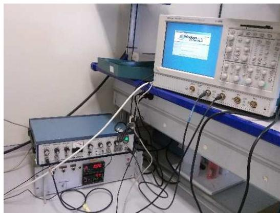
**Figura 3.3. Osciloscopio y generador-receptor empleados en las experiencias.**
