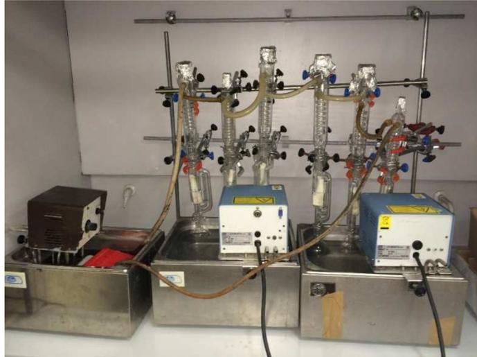
**Figura 3.13. Montaje experimental para la determinación del contenido en grasa.**
