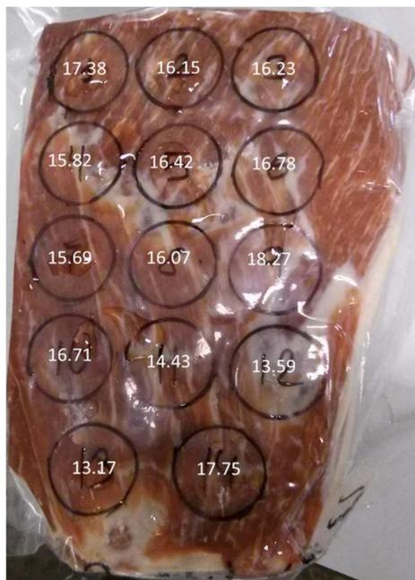
**Figura 4.9. Coeficientes de atenuación medios obtenidos en los diferentes puntos de medida de un jamón No Pastoso a 2°C utilizando un transductor de 1 MHz de banda estrecha.**
