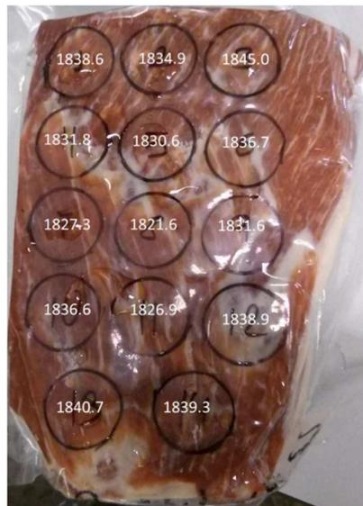
**Figura 4.2. Velocidades ultrasónicas medias obtenidas en las diferentes zonas de medida en una pieza de jamón No Pastoso a 2°C utilizando un transductor de 1 MHz banda ancha.**
