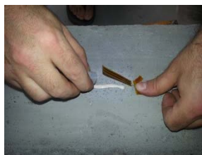
fig. 71 Vertido del adhesivo
