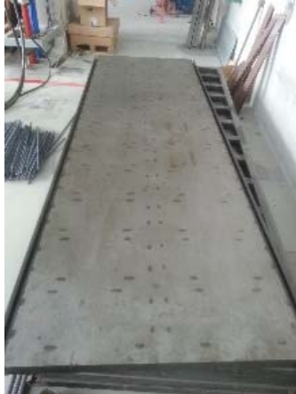
fig. 10 Plancha de encofrar.
