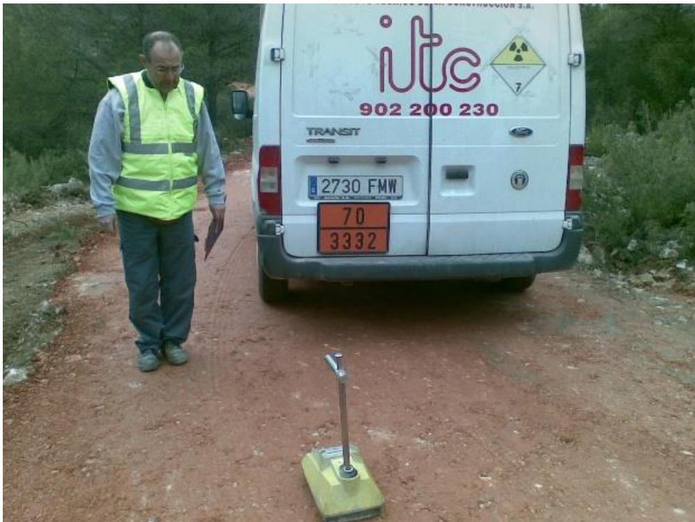
Foto10. Empresa control. Prueba con Isótopos. Fuente: propia.
