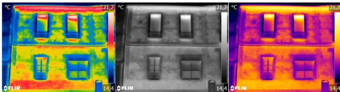
Figura 81. Fotografías térmicas en distintas paletas; Rainbow, Grey e Iron. Fuente propia.
