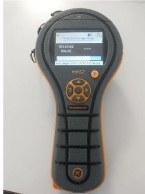
Figura 84. Medidor higroscópico. Fuente propia.
