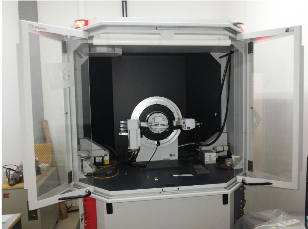
Figura 37. Fotografía de difractómetro rayos x. Fuente propia.
