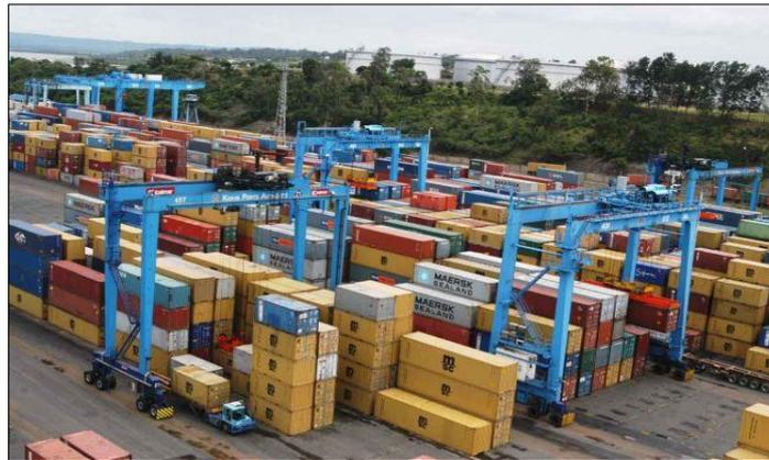
*Figura 7. RTGs operando en el subsistema de almacenamiento*
