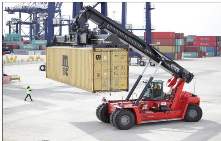
*Figura 8. Ejemplo de un Reach Stacker operando*
