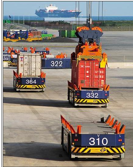
*Figura 10. Ejemplo de sistemas AGV desplazando contenedores*
