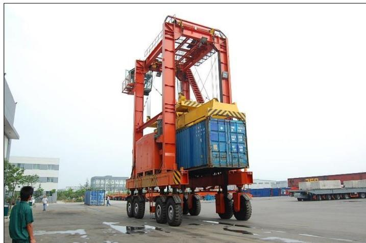
*Figura 9. Straddle Carrier manipulando un contenedor*
