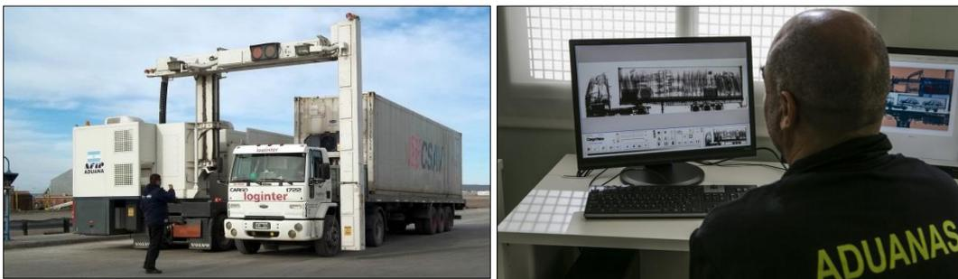
*Figuras 27-28. Camión pasando escáner reubicable de aduana. Monitorización del proceso*
