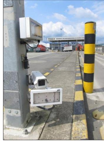
**Figura 24.** Elementos Sistema OCR
