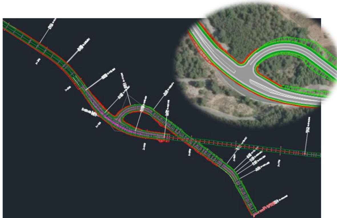
Fig. 9 Detalle del nudo oeste, en el P.K. 3+071,89, en la curva 9. Fuente: *Anejo 6 Diseño de los nudos*.
