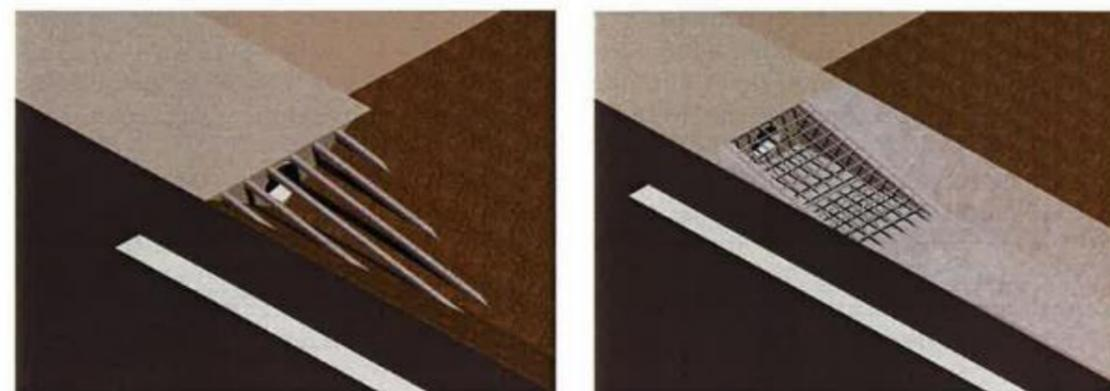
Fig. 18 Esquemas de algunos dispositivos para protección de paso salvacunetas. Fuente: Orden circular 35/2014.
