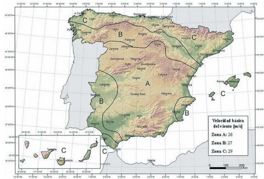
FIGURA 4.2-a MAPA DE ISOTACAS PARA LA OBTENCIÓN DE LA VELOCIDAD BÁSICA FUNDAMENTAL DEL VIENTO v_{b,0} (Coincide con el mapa correspondiente del Código Técnico de la Edificación)
