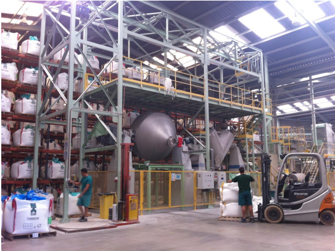
Imagen 12: Mezcladora bicónica y mezcladora en V de 2000 Kg. Fuente: Fotografía en planta sujeta a confidencialidad de la empresa (2013).
