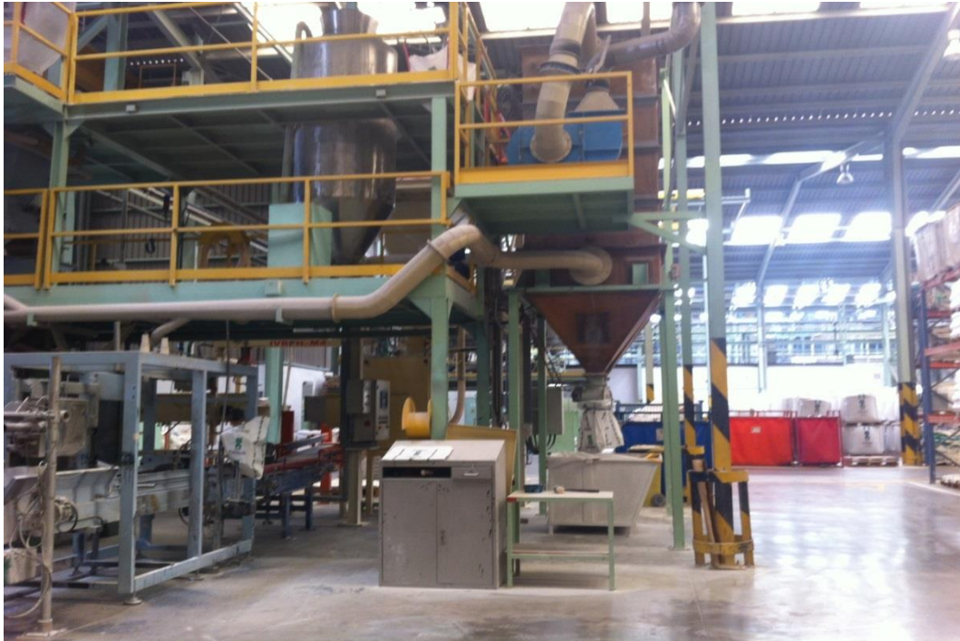
Imagen 14: Aspiración de los sacos de serigrafía y carga en el silo. Fuente: Fotografía en planta sujeta a confidencialidad de la empresa (2013).
