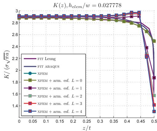
Figura 7. FIT, tamaño de elemento similar a la región afectada,  $h_{elem} = 0,083a$ .
