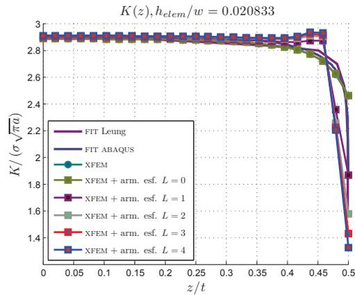
Figura 8. FIT, tamaño de elemento inferior a la región afectada,  $h_{elem} = 0,062a$ .
