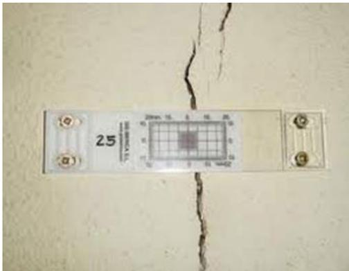
*Ilustración 48. Fisurómetro. Fuente Wikipedia.*
