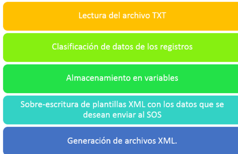
Fig. 29. Esquema general de funcionamiento del programa desarrollado en lenguaje JAVA para el parceo de archivos TXT a XML.
