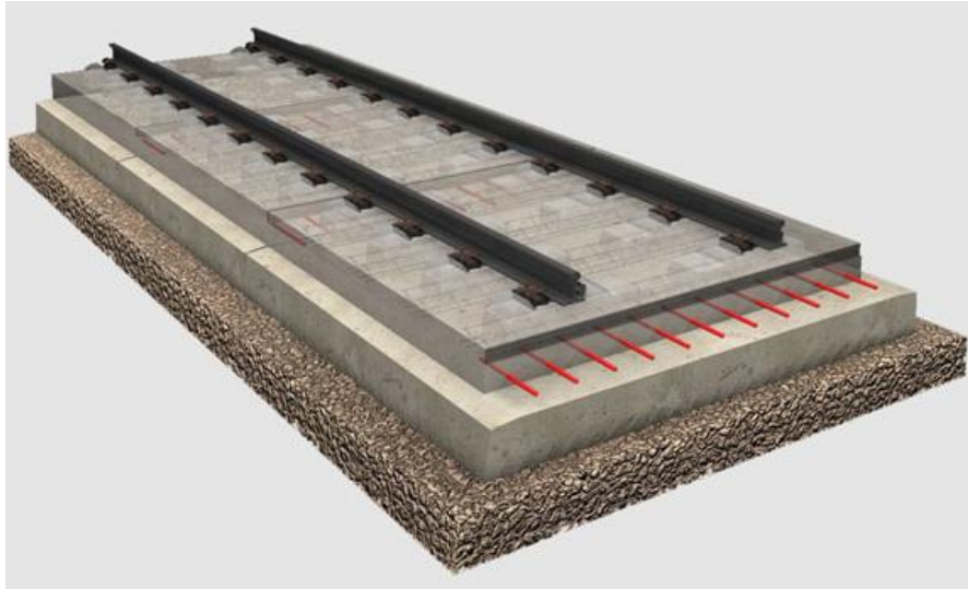
Imagen 7.23: modelo en 3D de la estructura de la vía en placa del sistema sin armadura continua sobre capa portante de balasto. Fuente: http://www.railone.com
