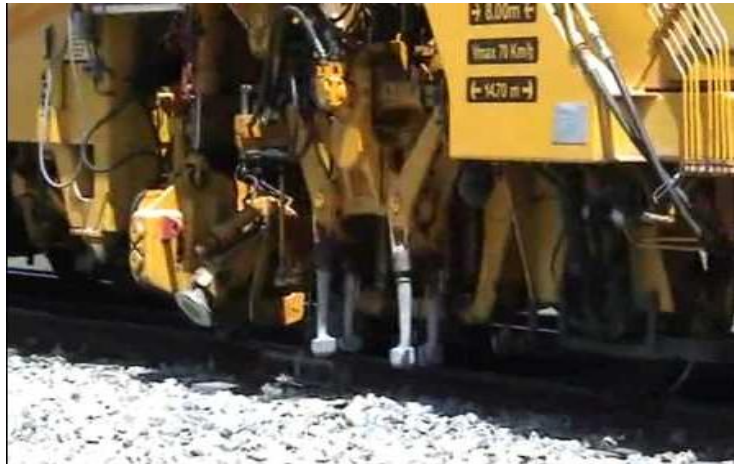
Imagen 7.17: detalle de los bates de una bateadora. Fuente: http://www.google.com
