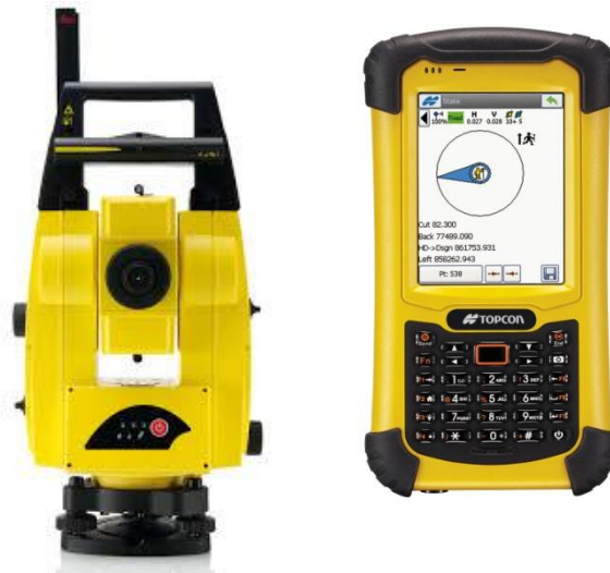
Imagen 7.1: Estación total robotizada Leica ICON robot 50, Fuente: http://www.leica-geosystems.es , http://apac.getac.com y elaboración propia.
