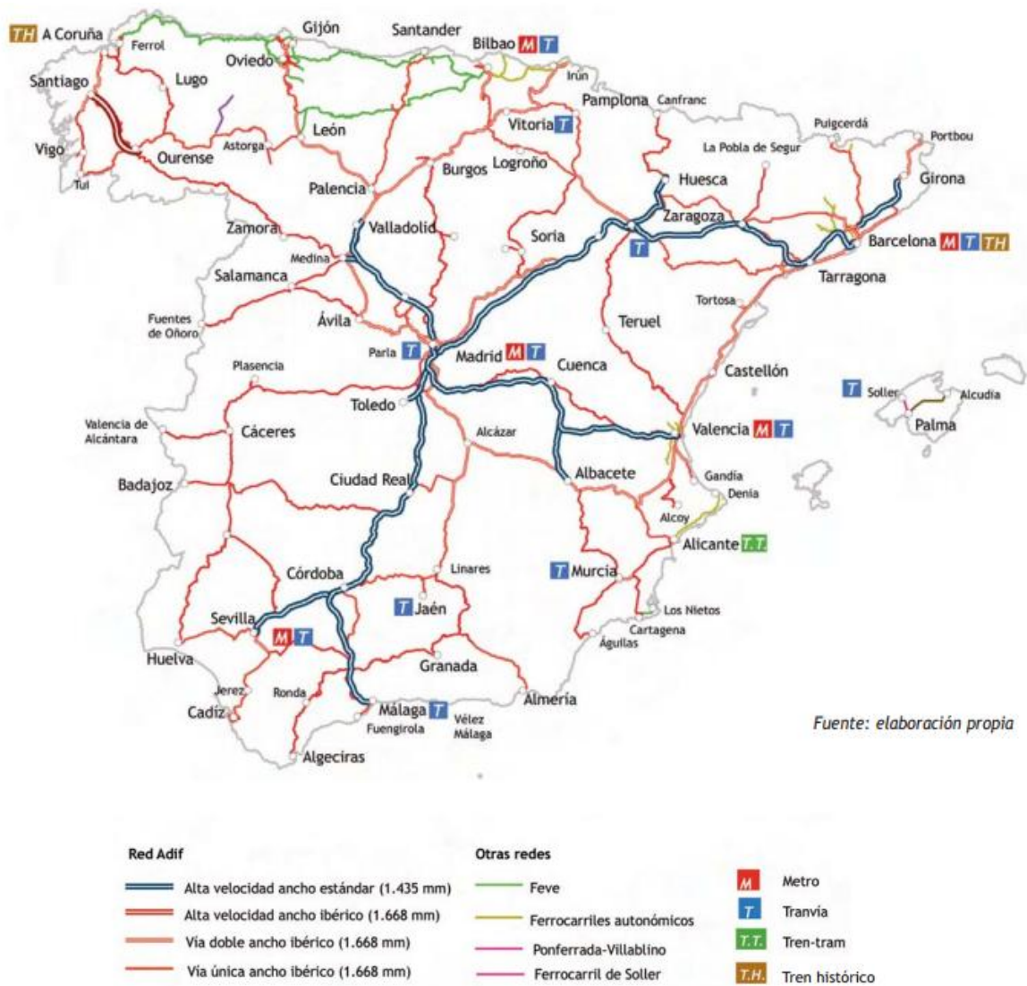
Figura 4.10: Red ferroviaria española en función de sus características y gestores – 31 de diciembre de 2011 - , Fuente: Anuario del Ferrocarril 2012
