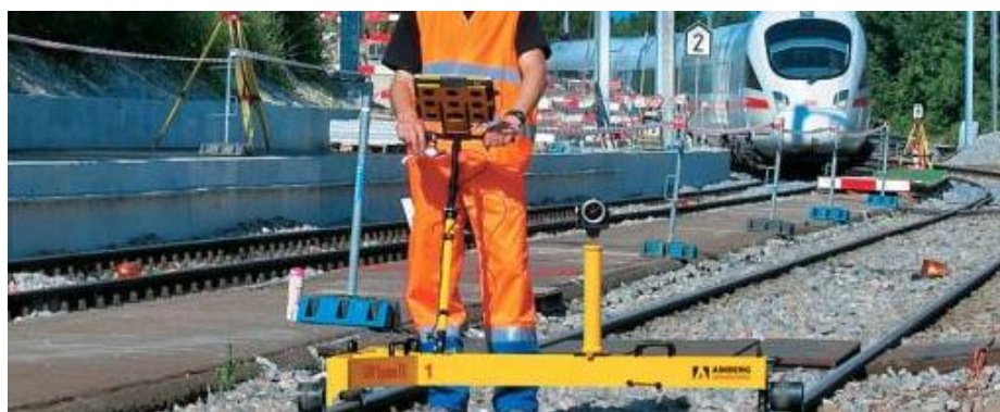
Imagen 7.21: auscultación con el carro de vías. Fuente: http://www.dosdemil.es
