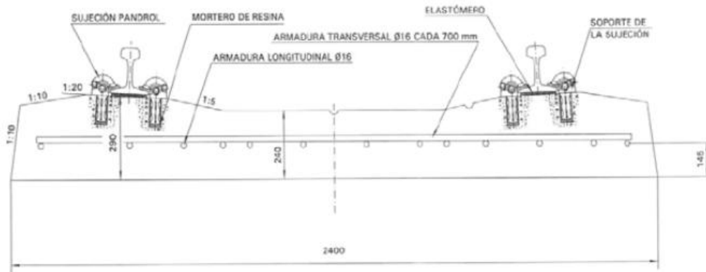
Figura 7.34: sección tipo del sistema de vía en placa de apoyo del carril colocado en el tramo Ricla-Calatorao de la línea ferroviaria Madrid-Barcelona.
