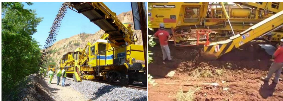
Imagen 7.20: Desguarnecedora trabajando. Fuente: http://www.google.com
