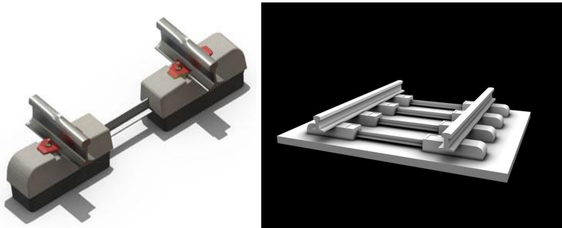
Figura 5.6: Vía en placa, sistema Stedef, Fuente: www.google.com
