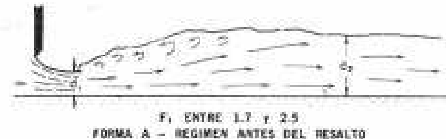
Figura 5. Resalto hidráulico con F 1 entre 1,7 y 2,5. USBR.
