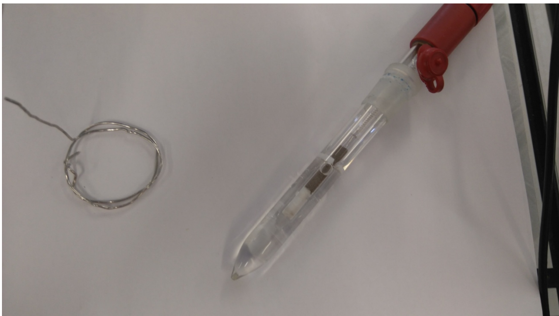
Figura 14. Electrodos utilizados. Derecha: electrodo de referencia, izquierda: electrodo auxiliar.
