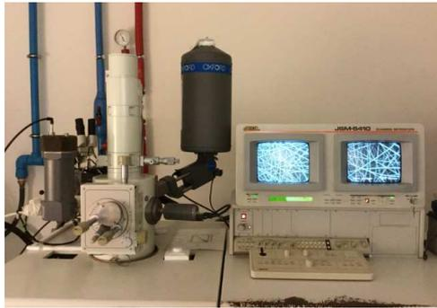
**Figura 4.17** Microscopio electrónico de barrido JEOL JSM – 5410 scanningelectronmicroscope.
