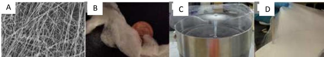
**Figura 2.9** (A) Nanofibras a partir de una solución de PEO; (B) Malla de nanofibras obtenida a partir de PS fundido; (C) Recolección de las nanofibras mientras se realiza la técnica de forcespinning; (D) Mallas no tejidas de nanofibras obtenidas por forcespinning (Sarkar et al., 2010).
