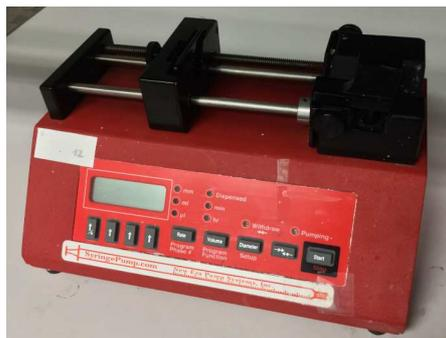
**Figura 4.2** Bomba de inyección.
