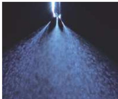
**Figura 2.4** Imagen de varios jets cuando se produce electrospinning (Jaworek et al., 2009).
