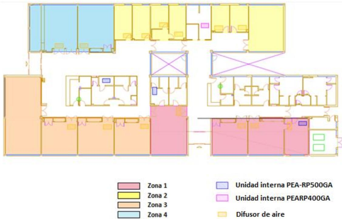
Figura 31: Zonas climatizadas, unidades exteriores e interiores.
