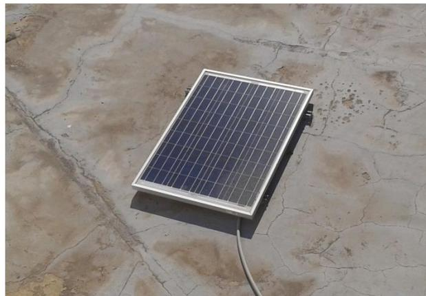
Figura 29: Placa solar del sistema de riego
