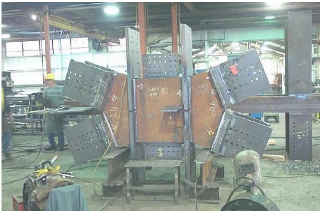
Figura 64: Imagen y esquema de uno de los nudos de la estructura. Fuente: McCain, Ian. Diagrid: Structural Efficiency & Increasing Popularity
