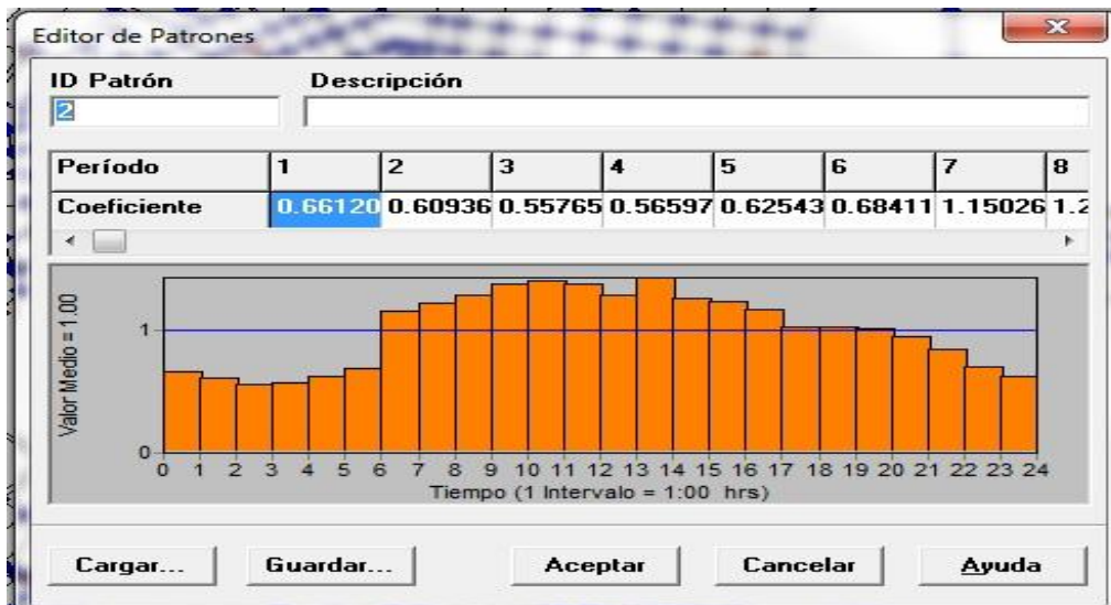
Figura 56 Curva de modulación nueva.
