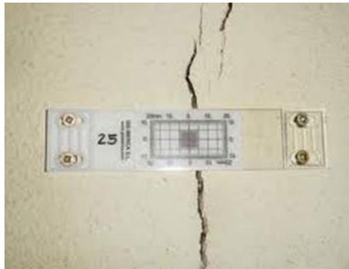
*Ilustración 57. Fisurómetro*
