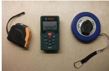
Figura 1. De izquierda a derecha: flexómetro, distanciómetro láser y cinta métrica. 2015. Fuente propia
