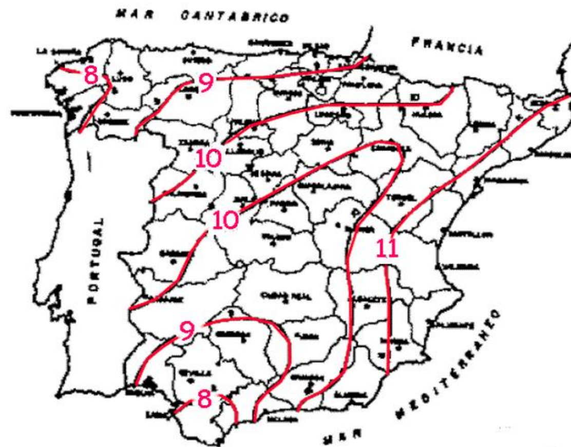
Figura nº02- Coeficiente I_i/I_d . Fuente: Instrucción 5.2-IC de Drenaje Superficial
