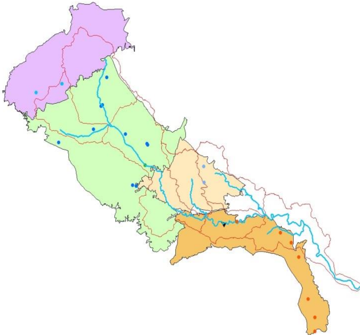
Figura 14: Masas de agua subterránea aguas arriba el embalse de Forata con piezómetros, estaciones de aforos y embalse
