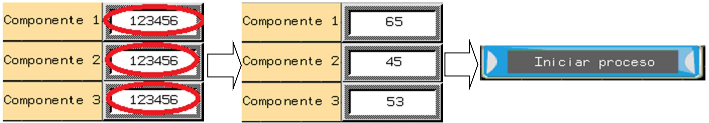
Figura 5.2.4. Esquema de inicio mediante introducción manual
