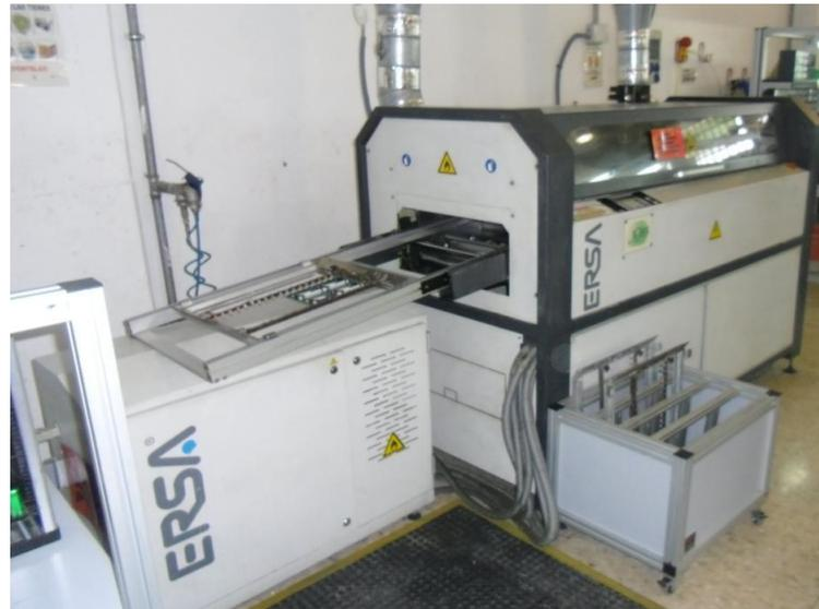
*Imagen 2.4: Sección de soldadura, máquina de ola*
