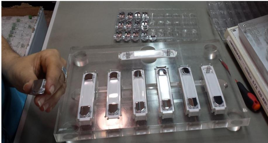
Figura 4.6: Conjunto del producto Pulsador N-City Doble AG en el proceso de montaje, obsérvese el útil de trabajo
