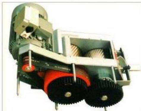
Imagen 11: Molino de malta eléctrico
