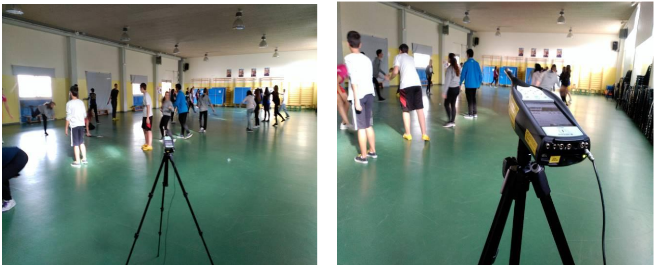
Figura 13. Realització de les mesures de soroll al gimnàs.
