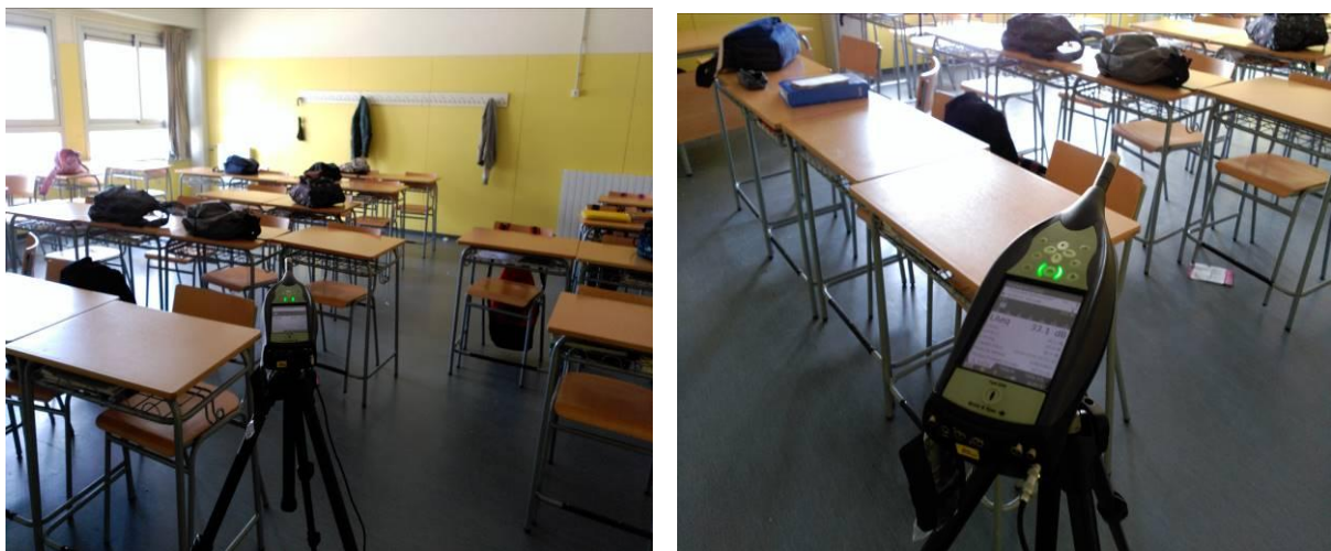
Figura 8. Realització de les mesures soroll de fons a l'aula de 2 de Batxillerat
