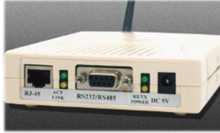
Figura 7 - Indicadores Lector RFID.
