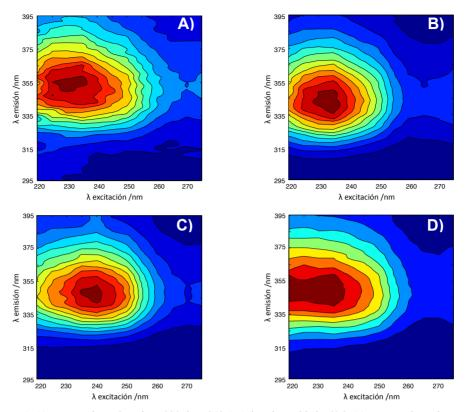
**Figura 1.** A) muestra de cuchara  $\lambda_{exc}$ =230,  $\lambda_{em}$ =353 (máximo intensidad =60.2; B) muestra de cuchara con la mezcla 5\*;  $\lambda_{exc}$ =235,  $\lambda_{em}$ =342 (máximo=252.7); C) muestra de cuchara con mezcla 8\*;  $\lambda_{exc}$ =240,  $\lambda_{em}$ =348 (máximo=244.1); D) muestra de cuchara con la mezcla 13\*;  $\lambda_{exc}$ =235,  $\lambda_{em}$ =349 (máximo=174.3).
