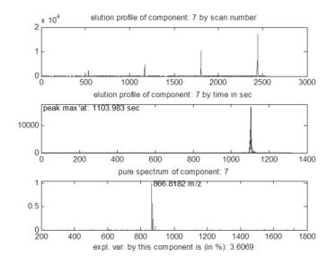
Figura 2. Componente 7 obtenido del análisis MCR-ALS de la matriz aumentada (2.5, 5, 10 y 20 ppm) dónde se muestran el perfil de elución anterior para cada muestra de la matriz. También se representan los perfiles de elución y de masas del componente en segundos y *m/z* respectiva-mente.
