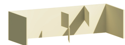
[Fig. 28] LOD 100. Proceso: muros. Fuente: elaboración propia.
