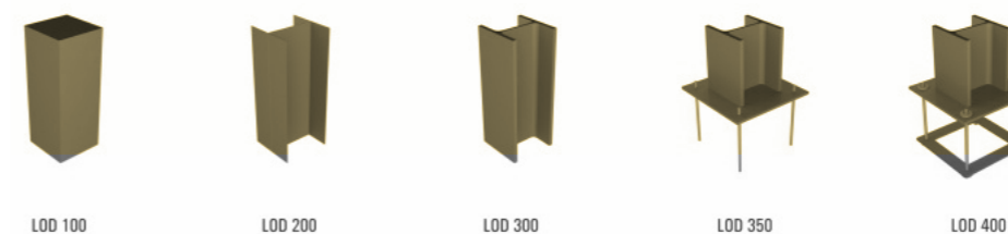
[Fig. 22] Niveles LOD: 100-200-300-350-400. Fuente: http://www.konstrukce.cz/clanek.cklop-bim-jako-nastroj-efektivniho-projektovani-vystavby-a-spravy/
