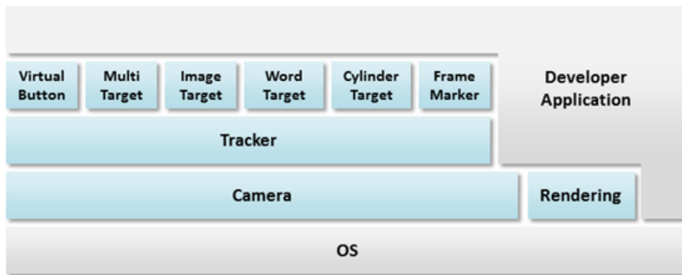
Figura 25. Diagrama a alto nivel de Vuforia.
