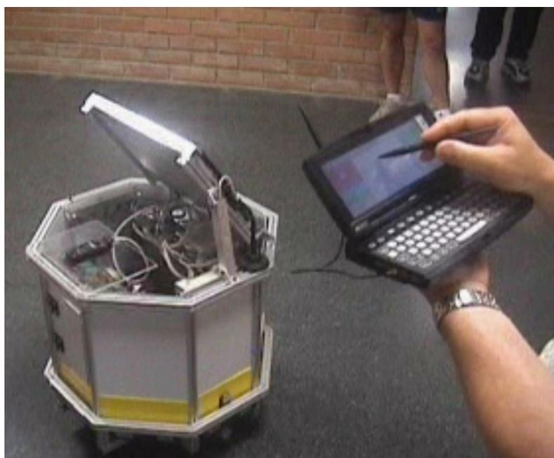
Figura 82: *Control del robot YAIR desde un nodo heterogéneo. El operario envía direcciones de movimiento sin preocuparse de los obstáculos*
