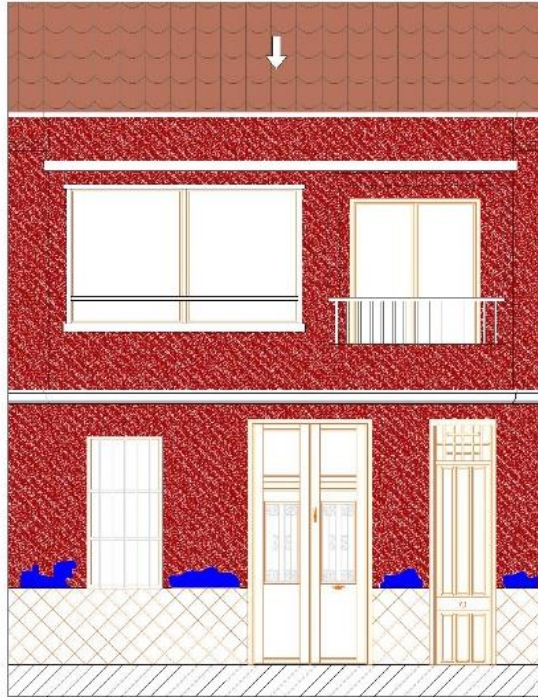
Figura 74: Humedad capilar en fachada. 2015. Fuente propia.
