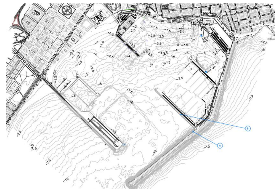
Figura 3. Emplazamiento de puntos de replanteo
