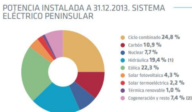
Figura 6. Potencia instalada por tipo de central en la península a 31/12/2013.
