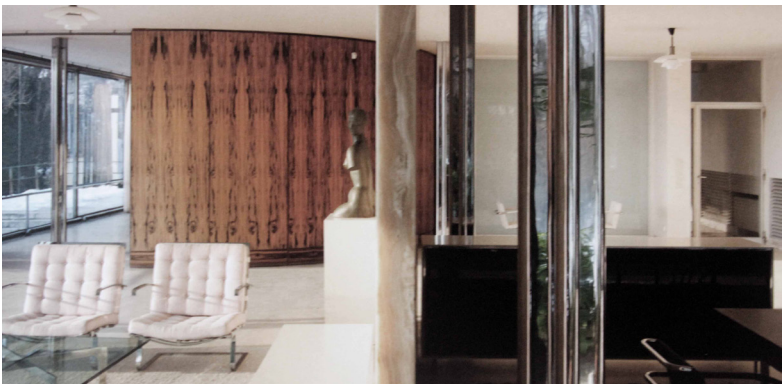
Fig. 29: Villa Tugendhat. Ejemplo de espacio creado a partir de materiales prefabricados, desde las particiones de madera hasta los cerramientos de vidrio o la estructura metálica. 2012.
