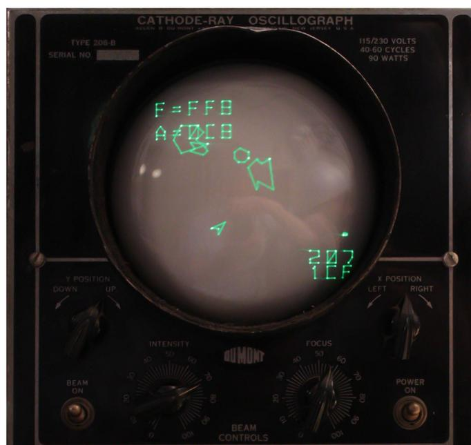
**Figura 2.9:** Un osciloscopio que simula un monitor de vectores en el que se está jugando a *Asteroids*.
