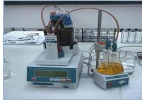
Figura 3.5. Instrumentación para la determinación Oxígeno mediante el Método Winkler.
