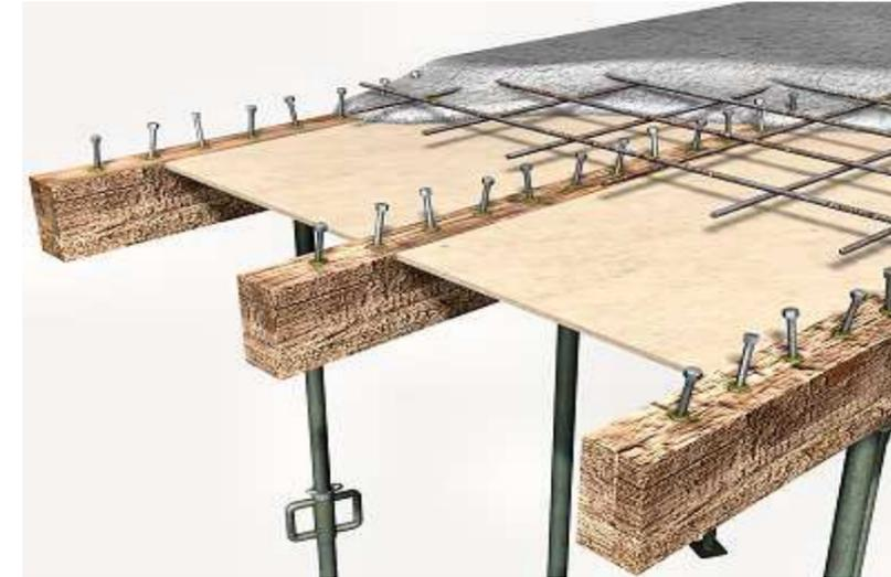
FIG. 66 . Refuerzo de forjado ([www.generadordeprecios.info](http://www.generadordeprecios.info))
