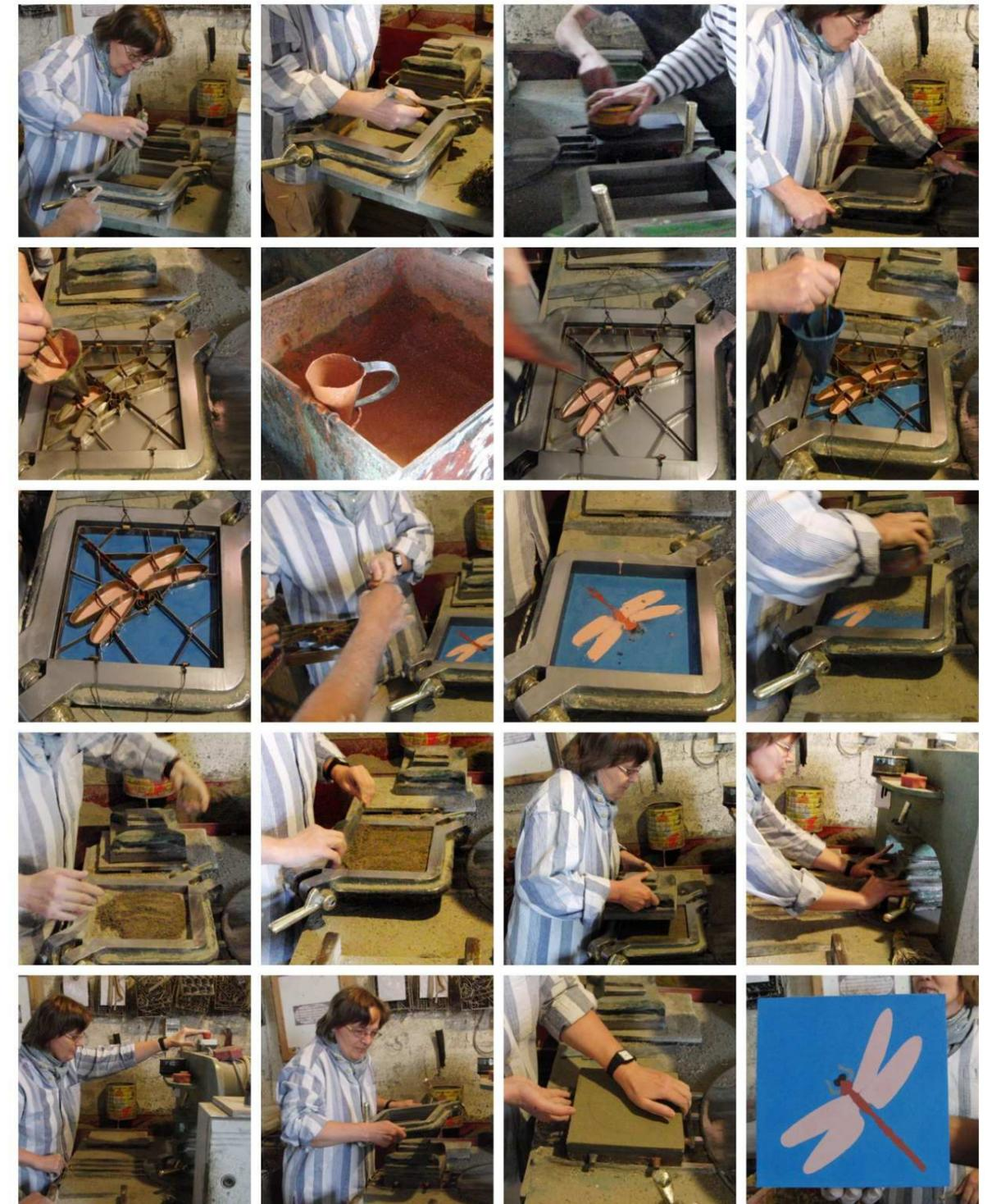
FIG. 49 . Ejemplo de fabricación artesanal de la vadosa hidráulica ([www.baldosasbalmoca.com](http://www.baldosasbalmoca.com))
