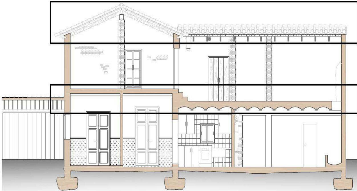
FIG. 43 . Sección longitudinal se la Alquería Montañana. Tipos de forjados. Fuente: autor propio
