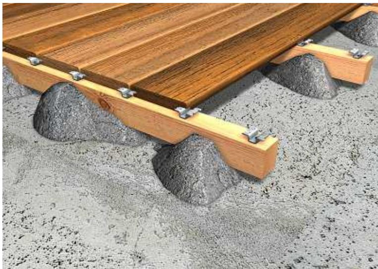
FIG. 61 . Pavimento de tarima fijadas sobre rastreles ([www.generadordeprecios.info](http://www.generadordeprecios.info))
