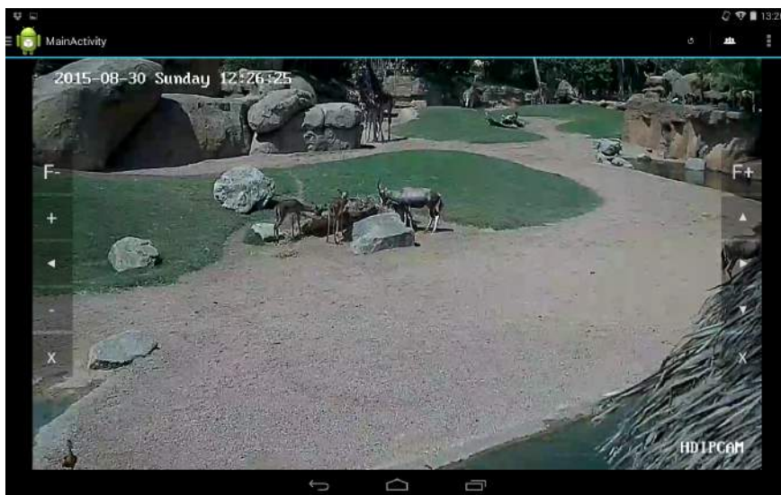
Figura 2.16: Interfaz con botones en la parte lateral, tipo de desplazamiento continuo y modo avanzado.
