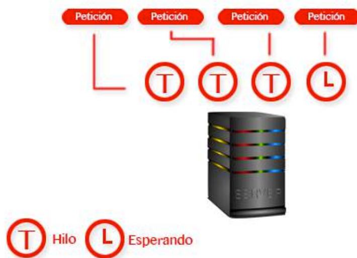
Figura 3.3: Esquema sobre la delegación de tareas al pool de hilos.
