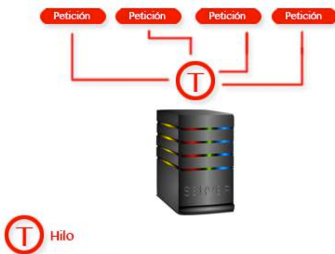
Figura 3.4: Esquema sobre la delegación de tareas al pool de hilos.
