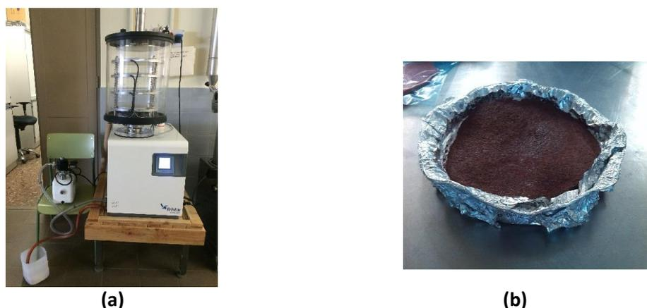
**FIGURA 1.** Equipo en el que se realizó la liofilización de las muestras (a); muestra liofilizada en bandeja (b)
