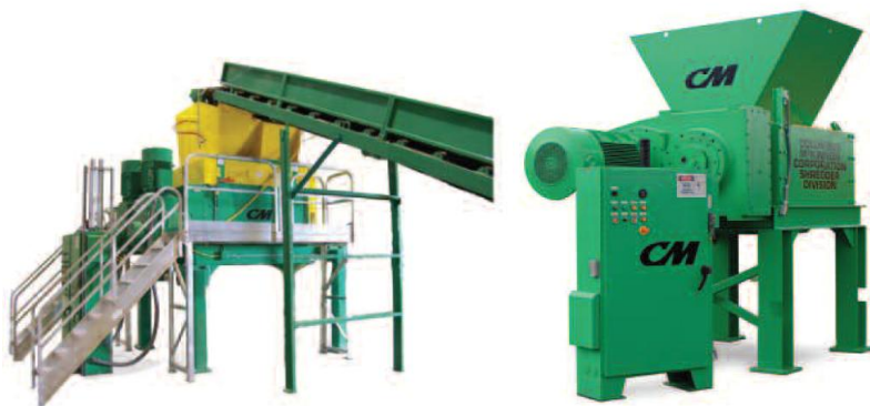
Figura 10. Pretritador y triturador de neumáticos. (CM Industrial Products, 2014)
