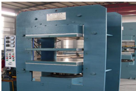
Figura 15 .Prensa vulcanizadora de caucho. (CM Industrial Products, 2014)
