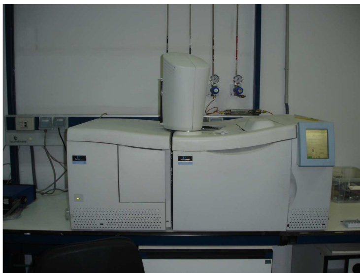
Figura 30. Fotografía de cromatógrafo de gases y un detector de masas Clarus 500 GC-MS
