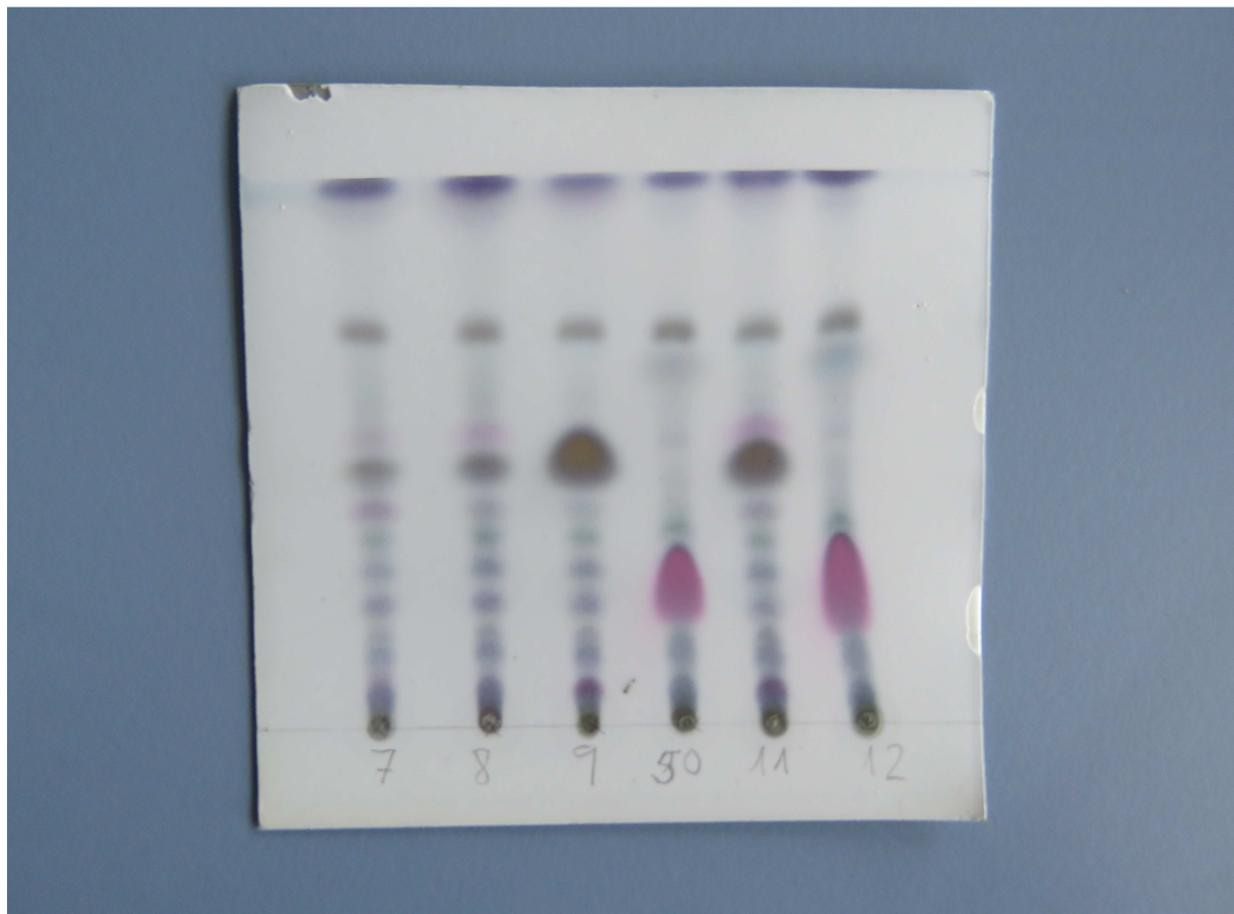
Cromatograma tratado con vainillina y ácido sulfúrico 3
