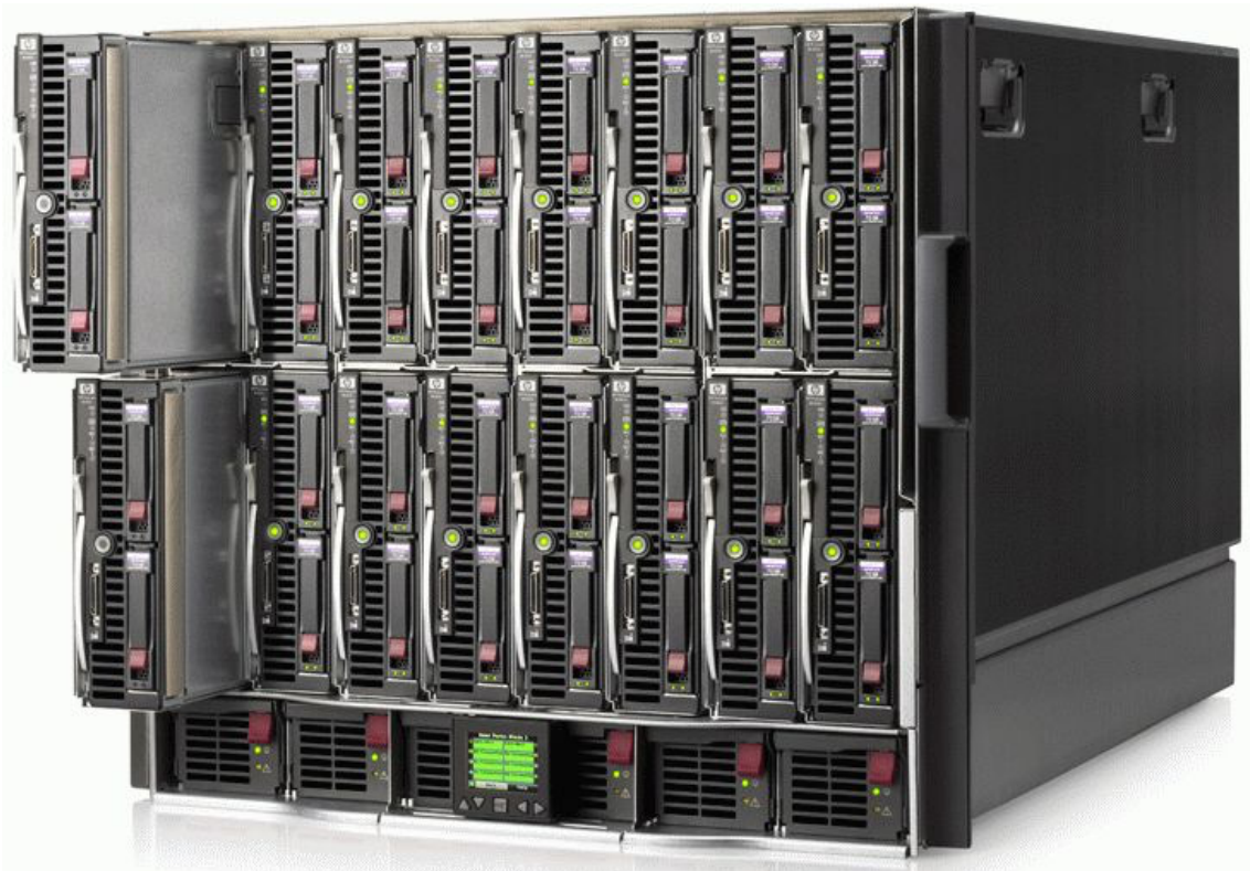
Figura 2.4: Vista frontal de un chasis HP donde se aprecian varios blades sin conectar
